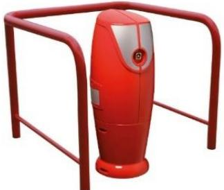
Il doit être situé à une distance comprise entre 1 mètre et 5 mètres du bord de la chaussée accessible aux véhicules de Secours et de lutte contre l'incendie, et ses demi-raccords doivent être orientés du côté de la chaussée.
